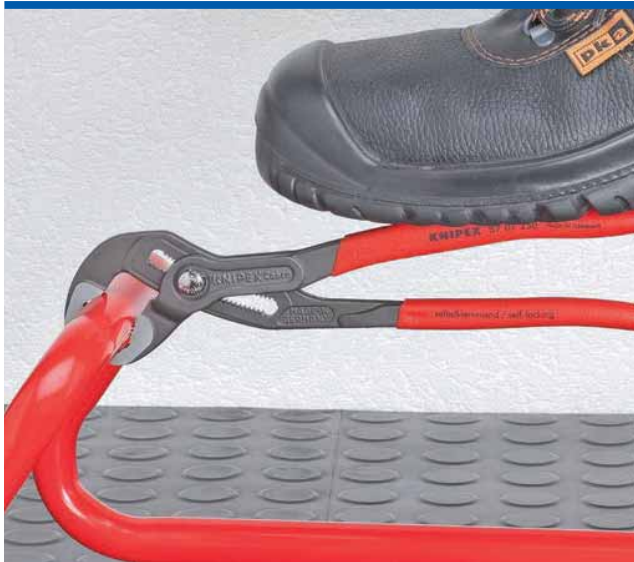
Los dientes desplazados con respecto al sentido de giro provocan un efecto de auto-retención y evitan el deslizamiento sobre la pieza.
